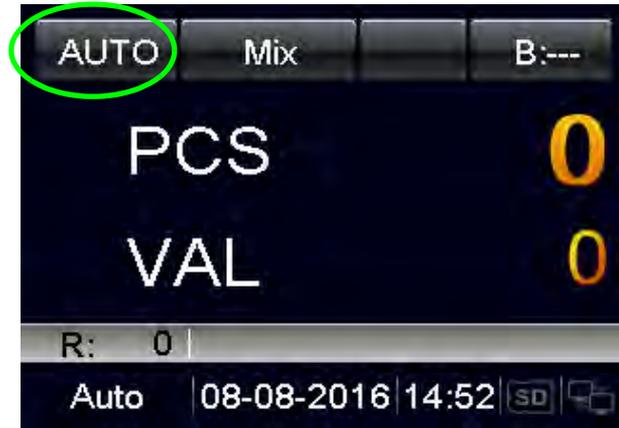
Die Maschine erkennt die Währung anhand der ersten Banknote, vorausgesetzt, dass die Währung im Auswahlmeneü AUTO CUR auf ON (ein) geschaltet ist.
