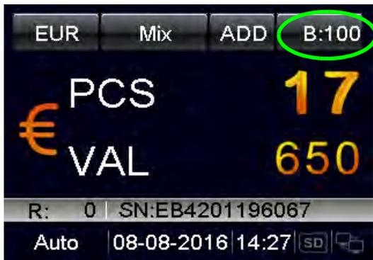
Durante il conteggio la macchina si arresta una volta raggiunto il valore preimpostato per il batch.
